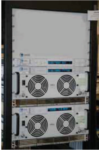
400W C-Band, 1:1 4RUラック・リダンダント・システム、N+1リダンダント電源オプション付。
